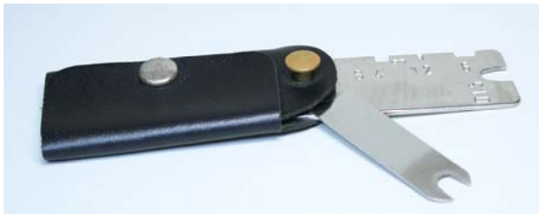
Prüflehre für Degen und Säbel
