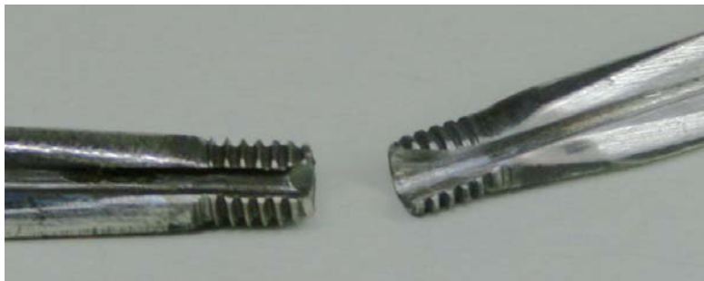
(Litzenkanal wie rechts ausweiten oder auffeilen)
