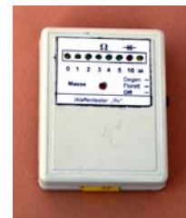
Ohmmeter mit LED's
